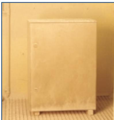
**Essai de pénétration contre les solides : ici, essai à la poussière de talc**
