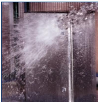
Essai de protection contre les projections d'eau IP x6
