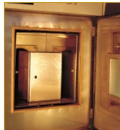
Essai en enceinte climatique permettant de recréer les conditions d'humidité et de condensation
