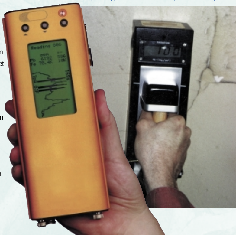
Exemples d'appareils de détection du plomb dans les peintures.
